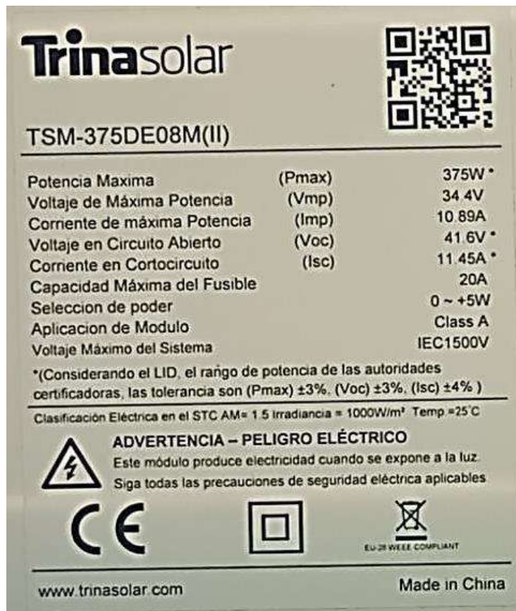
Imagen 49. Características de paneles solares instalados
