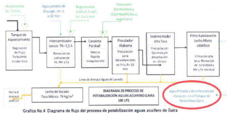
Ilustración 1 Diagrama de flujo del proceso de potabilización aguas acuífero de Gaira Fuente: Documento "MEMORIAS PLANTA DE AGUA POTABLE GAIRA"
