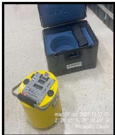
Imagen 68 Medidor de compactación
