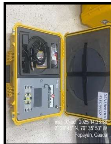
Imagen 70 Medidor no nuclear.
