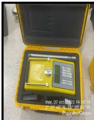
Imagen 69 Medidor no nuclear.
